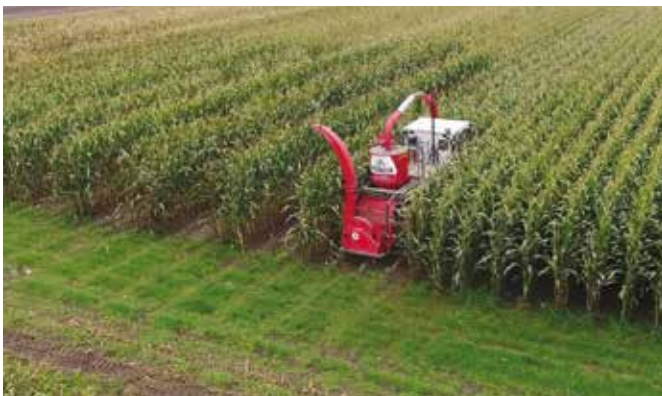
In Nederland heeft Pioneer een 20-tal maisproefvelden. De opbrengst van de maisproefvelden wordt bij de oogst gemeten door middel van een 2-rijige proefveldhakselaar en de kwaliteit wordt bepaald met onder andere de hulp van Eurofins Agro.
