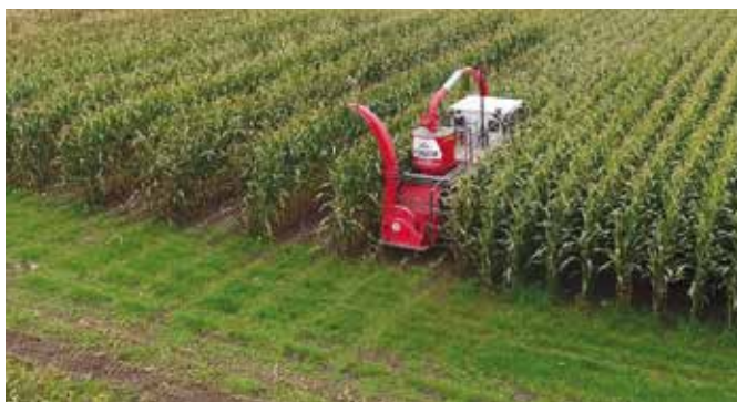
In Nederland heeft Pioneer een 20-tal maisproefvelden. De opbrengst van de maisproefvelden wordt bij de oogst gemeten door middel van een 2-rijige proefveldhakselaar en de kwaliteit wordt bepaald met onder andere de hulp van Eurofins Agro.
